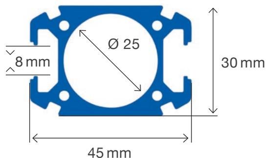
Das Design des **PPS SQ**-Profils umfasst eine Nut, die Verwendung von Zubehör (Nutensteine usw.) ermöglicht, **das mit den meisten auf dem Markt erhältlichen Profilen kompatibel ist.**
