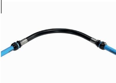
Bei Temperaturschwankungen dehnt sich das Aluminium aus bzw. zieht sich zusammen (Dilatation und Kontraktion). Zum Ausgleich sind entsprechende Absorptionsvorrichtungen an den Leitungen vorzusehen.
