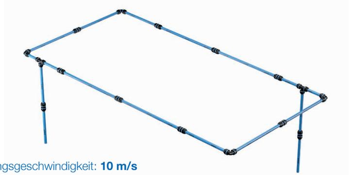
Druck: **8 bar** | Max. Druckverlust **5 % (0,4 bar)** | Max. Strömungsgeschwindigkeit: **10 m/s**
